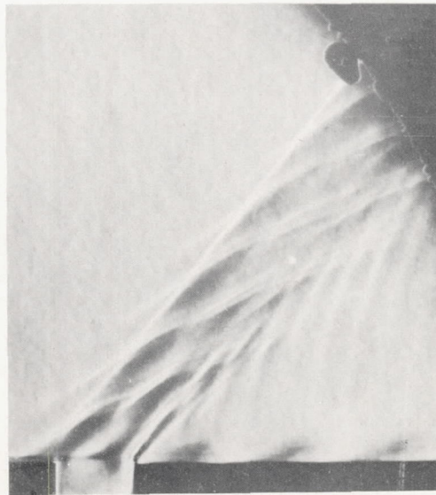
(d) M_\infty = 1.384 ; T_0 = 116.8^\circ \text{ F} . Knife edge vertical.
