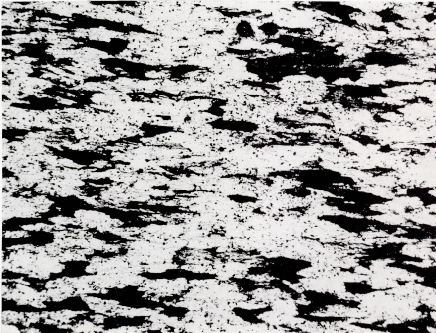
(d) Extruded transverse specimens. Etched in Keller's etch; 50X.
