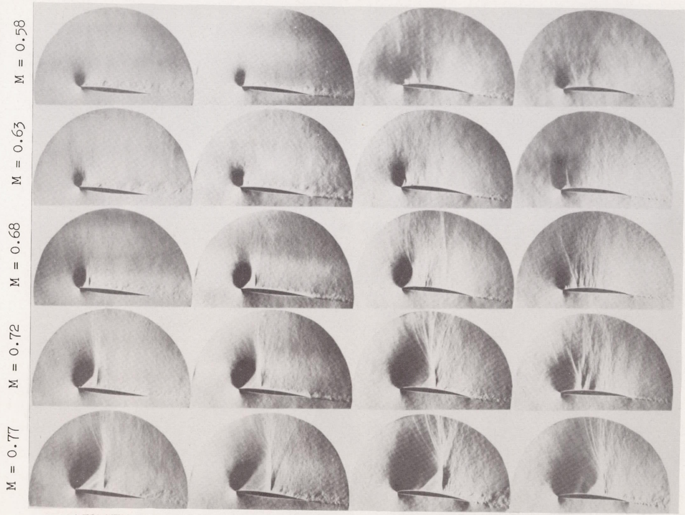
NACA 64A006; \alpha = 6^\circ . NACA 64A206; \alpha = 6^\circ . NACA 64A506; \alpha = 6^\circ . NACA 64A506; \alpha = 4^\circ .
