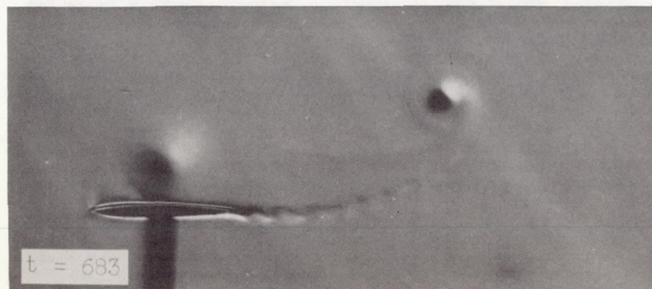
(d) Configuration 5; \alpha_B = 31^\circ ; no jet flow; p_2 - p_0 = 2.65 psi. L-57-2791
