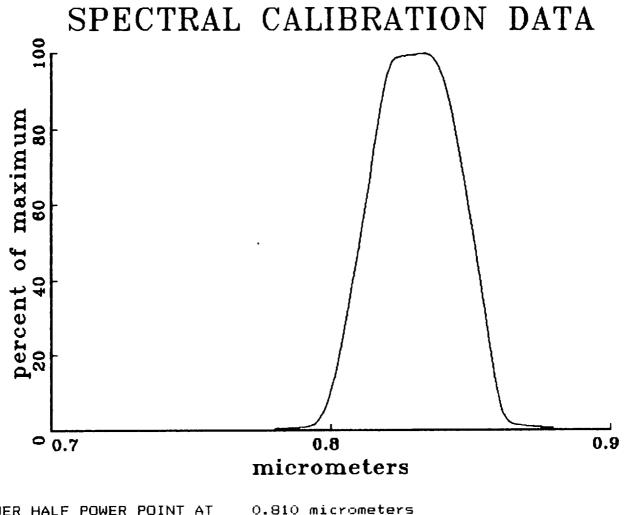
LOWER HALF POWER POINT AT UPPER HALF POWER POINT AT PEAK POWER AT 0.810 micrometers 0.852 micrometers 0.834 micrometers
