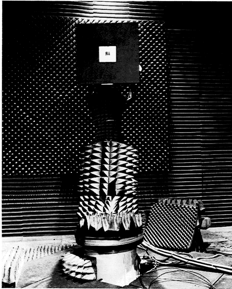
Figure 5-1. Subarray Module in Antenna Range Fixture
