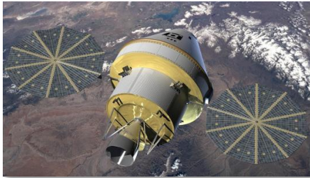
ATK UltraFlex 14 kW array
