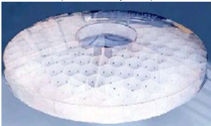
ATT – Waterjet Cut Core – Low Temp Fusion – 1990's
