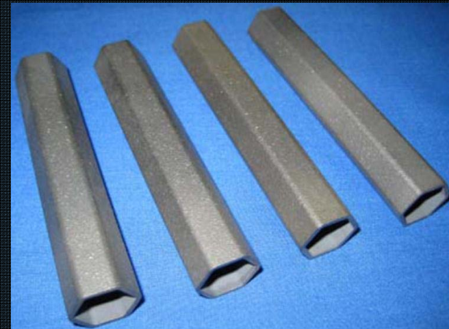
External W clads (VPS)
