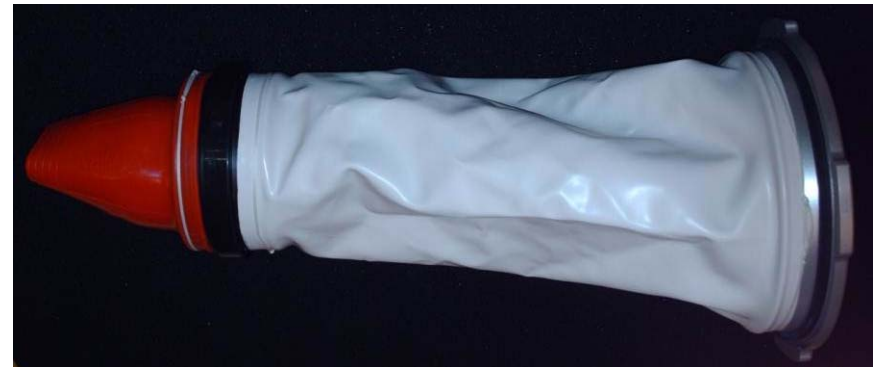
MSG Iris & Gauntlet Configuration
