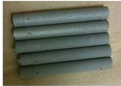
10 x 70 mm (od x h) Ti 6-4 alloy cylindrical bars
