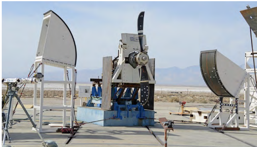
Figure 11.—Open-rotor fan blade-off test rig.
