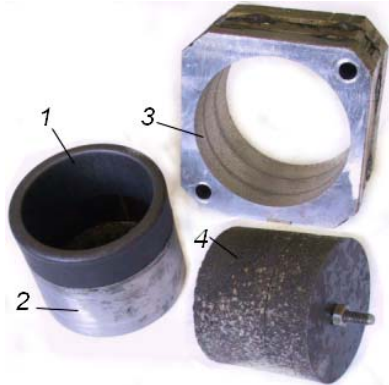
1 – ЕІ; 2 – електродотримач; 3 – деталь (отвір \varnothing 110 мм); 4 – відхід
