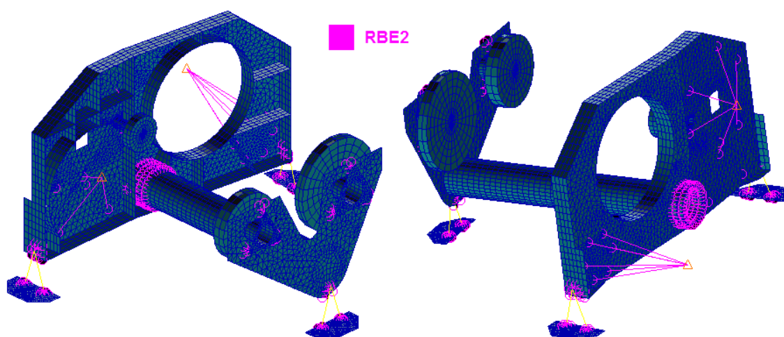
Figura 4.6: Immagine del modello FEM con evidenziati gli elementi RBE2 utilizzati.
