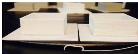
Figure 43. Pièce d'ABS blanche imprimé à 220°C (gauche) et à 240°C (droit)
