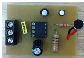
Figura 4-1 Placa amb micròfon i circuit d'adaptació del senyal
