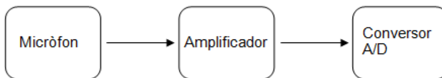
Figura 3-4 Esquema de blocs pel sistema d'adaptació del senyal
