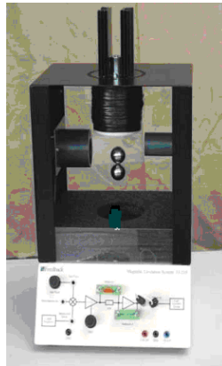
Figura 21. Experimento 11, levitación de dos esferas
