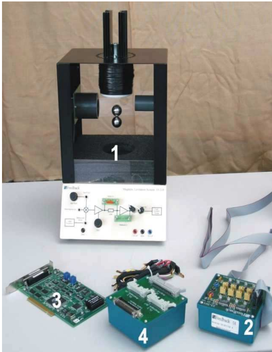
Figura 3. Componentes físicos del Maglev
