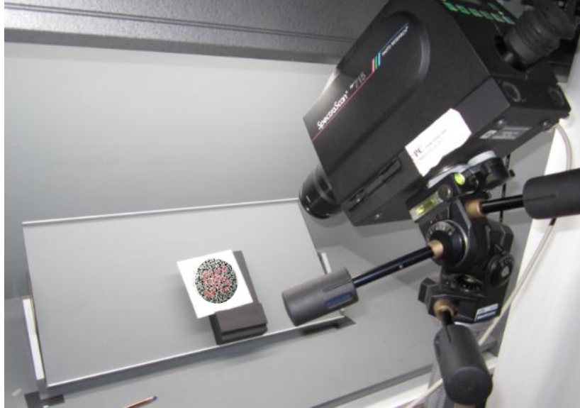
Figura 4.4.1. Espectrofotómetro SpectroScan PR 715 y cabina de iluminación VeriVide, midiendo el color de la lámina 25 del test de Ishihara.
