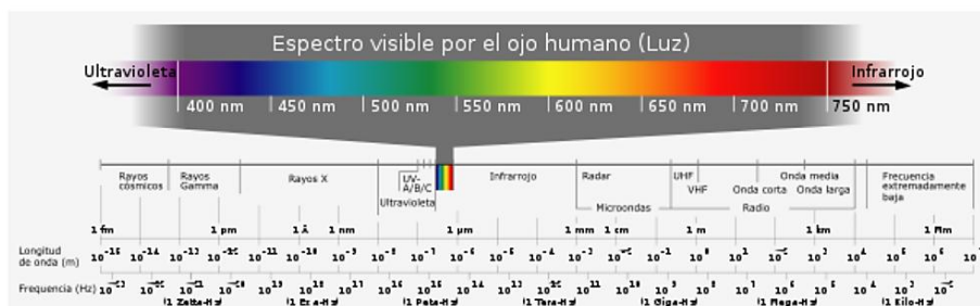
Figura 1.1. Sensibilidad a la longitud de onda de la especie humana. (Espectro visible, Wikipedia)
