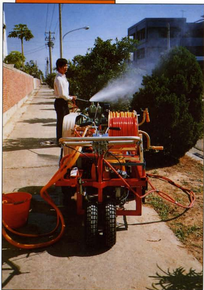
圖五、圖六：利用本機械實施地面病蟲害防治或葉面施肥之作業情形
