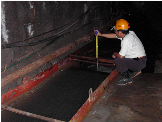
照片 1. 讀取量水堰水位
