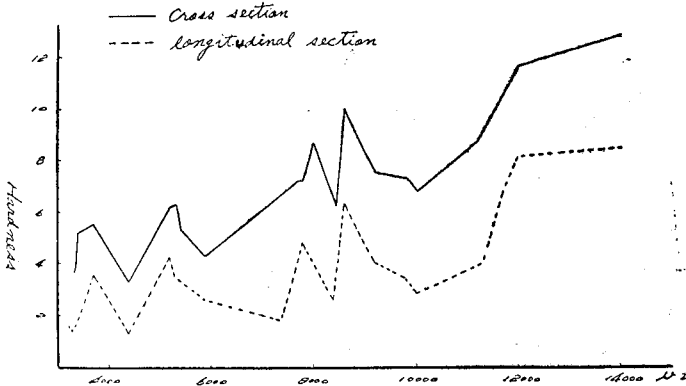
圖 3：單位面積內細胞壁斷面積與硬度之關係。
