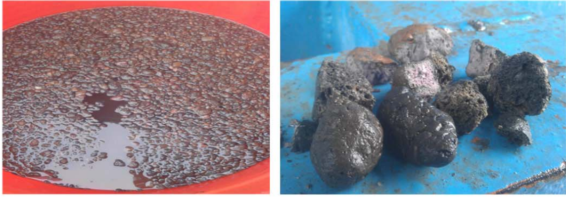
圖 4-5 上浮、大孔隙的輕質骨材
