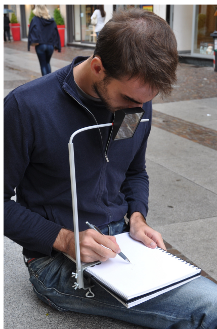
Figg. 3-4: Sistema di fissaggio proposto da Wollaston (Amici, 1819) e la nostra soluzione.
