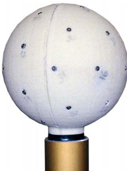
*Fig. 5.9 - Array sferico a 32 canali*
