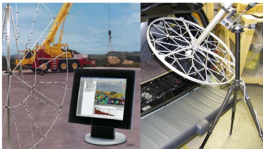
Figura 2.1 - A sinistra Wheel Array a 90 elementi e software PULSE™ associato. A destra la versione con 66 microfoni
