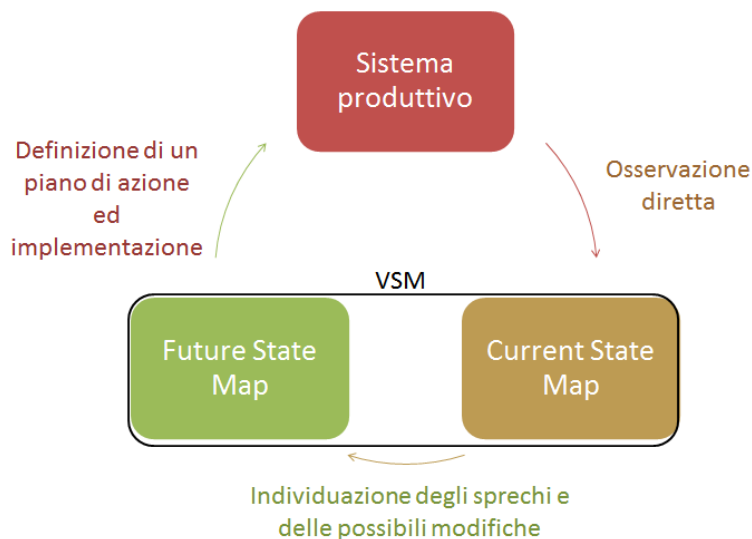
Figura 3: schema di processo da seguire nell'applicazione della VSM.
