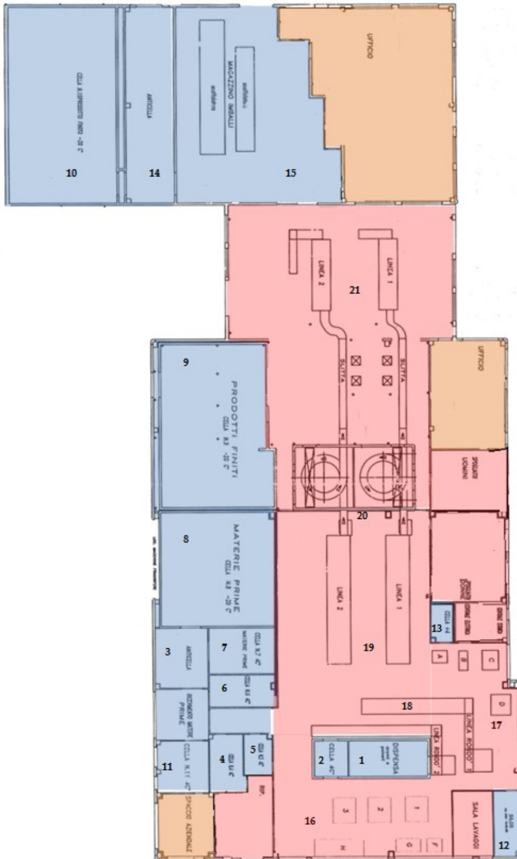
Figura 10: layout Righi s.r.l., suddiviso in area uffici (arancione), produzione (rosso) e magazzini (azzurro).
