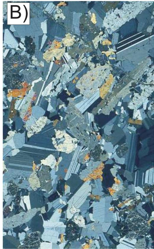
Fig. 5. Campione St12 (gabbro) - Stillwater Complex. Cristalli di cumulo di pl; cristalli di cumulo e di intercumulo di opx e di cpx. Scansione a nicols paralleli (A) e a nicols incrociati (B).
