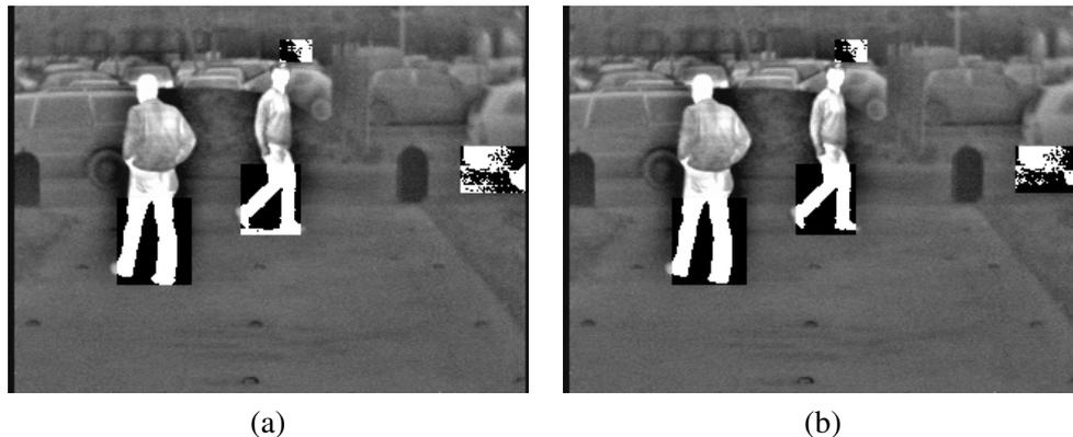
Figura 2.16: Esempio di binarizzazione della parte inferiore del bounding box quando la soglia è calcolata indipendentemente per tutte le fasce orizzontali (a), e quando alla fascia inferiore si applica una soglia pari alla media delle altre (b).
