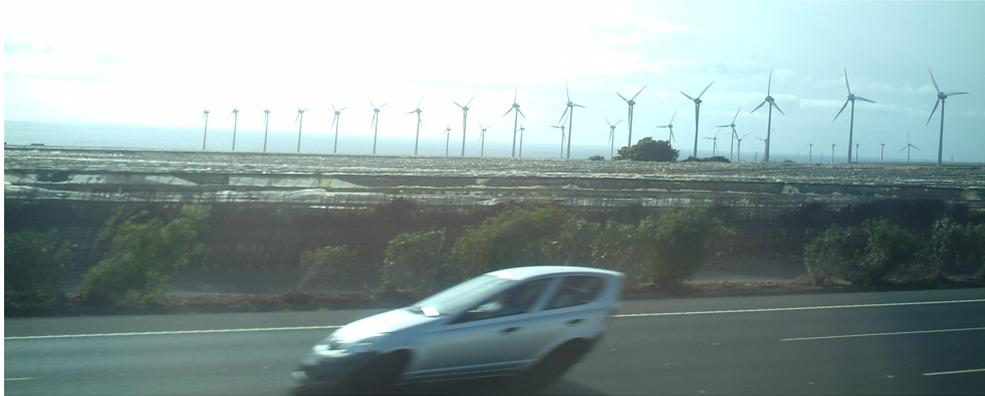
Figura 1.3: Effetto generato dal rolling shutter: quando la telecamera è posta in movimento, l'acquisizione delle righe in istanti diversi provoca la tipica distorsione visibile nell'immagine.
