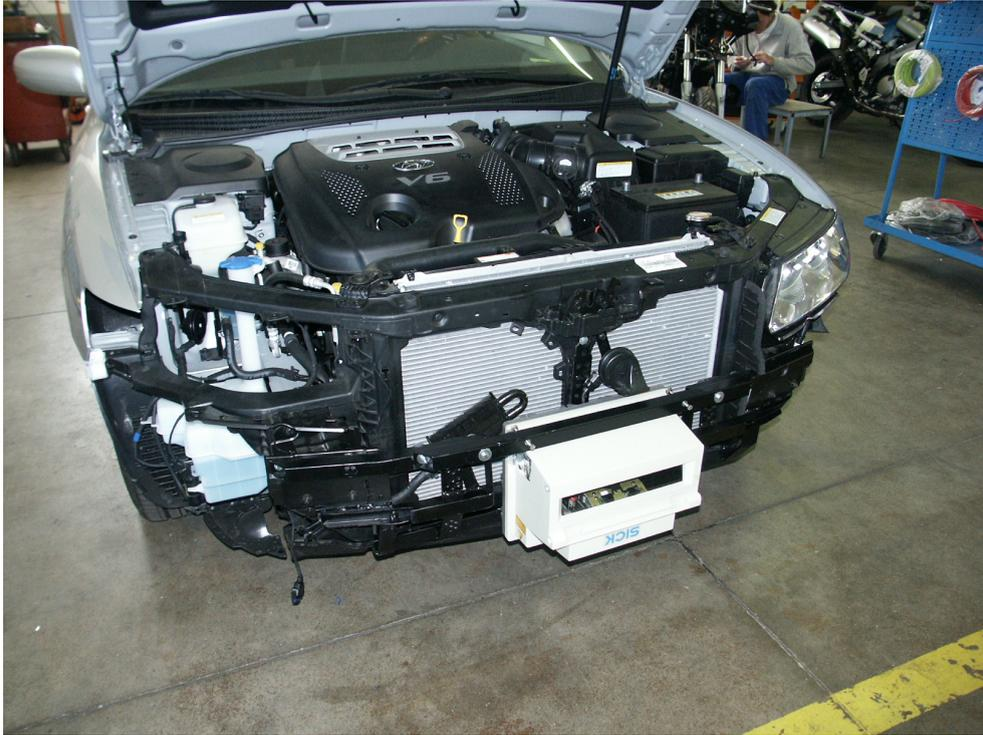
Figura A.3: Intervento meccanico per l'installazione del laserscanner nella parte frontale del veicolo.
