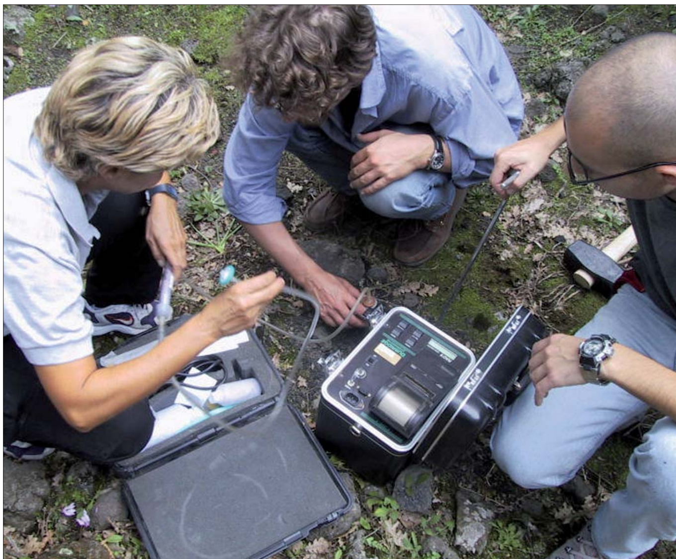
Figura 2 – Campionamento di radon e thoron mediante lo strumento RAD7.
