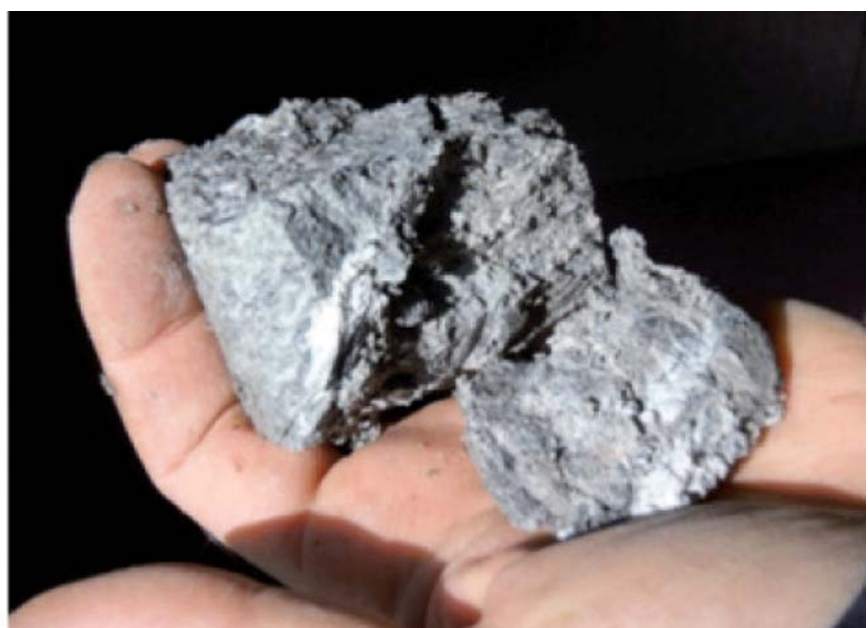
Figura 5 – Esempi delle rocce del sondaggio in avanzamento nella zona core zone: Cataclasite e Cachirite. (Foto S. Skuk)
