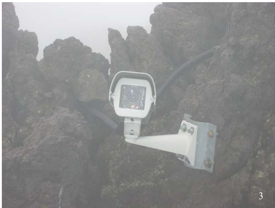
Fig. 3. La telecamera Sony FCB 470 LP dentro l'apposita custodia stagna.
