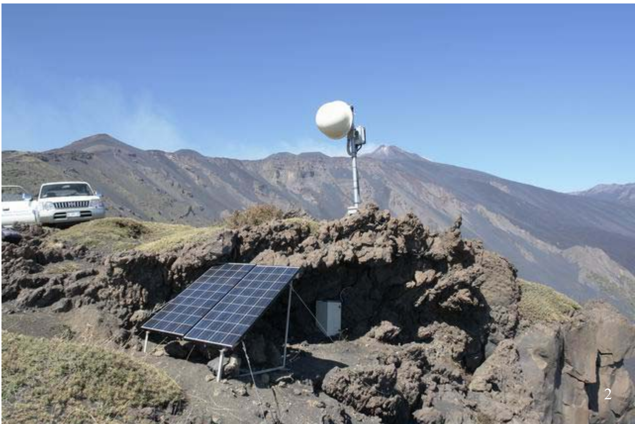
Fig. 2. La stazione video completa installata sul costone roccioso in località Schiena dell'Asino.
