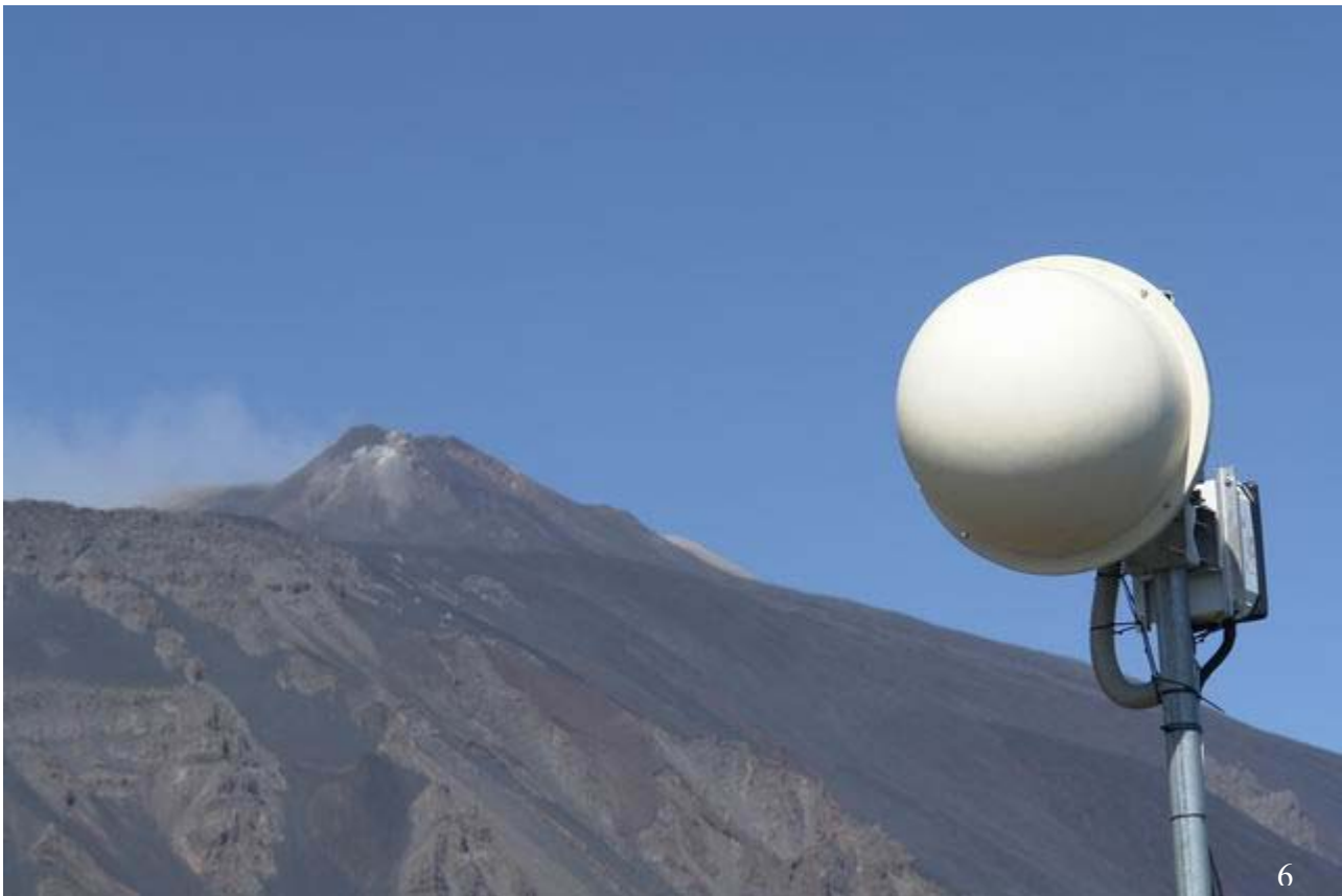
Fig. 6. La parabola ed il trasmettitore video necessari per l'invio delle immagini al CUAD.
