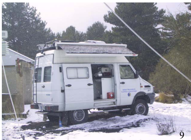
Figura 9. Mezzo mobile dell'Istituto Nazionale di Geofisica e Vulcanologia con all'interno la telecamera Sony FCB 470 LP e il radiometro.
