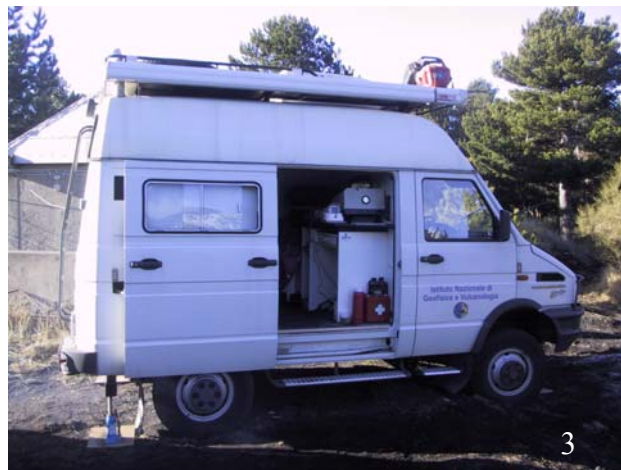
Figura 3. Mezzo mobile dell'Istituto Nazionale di Geofisica e Vulcanologia con all'interno la telecamera Sony FCB 470 LP e l'FTIR.
