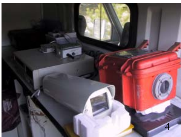
Figura 4. La telecamera Sony FCB 470 LP, il videoregistratore time-lapse Panasonic AG 6040 ed il radiometro all'interno del mezzo mobile.
