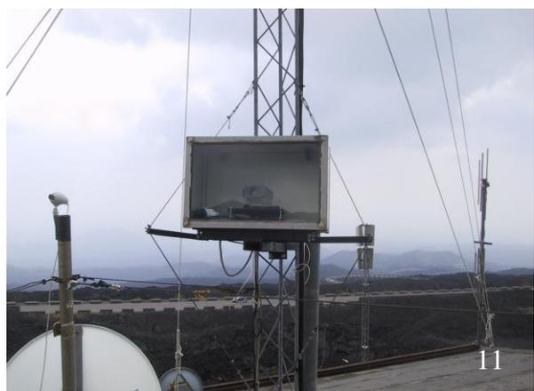
**Figura 11.** Custodia stagna contenente la telecamera Sony Evi D31 fissata ad un traliccio sul tetto dell'Hotel Corsaro.
