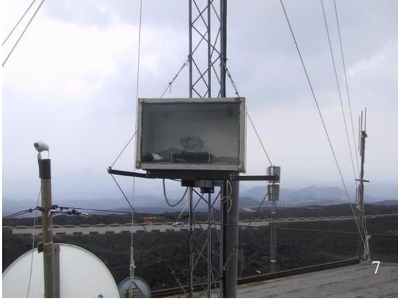
fig. 7 Custodia stagna contenente la telecamera Sony Evi D31 fissata ad un traliccio sul tetto dell'Hotel Corsaro.
