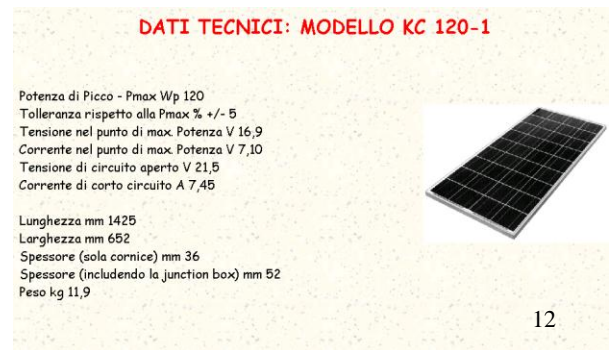
fig.12 Dati tecnici dei moduli fotovoltaici utilizzati a Stromboli
