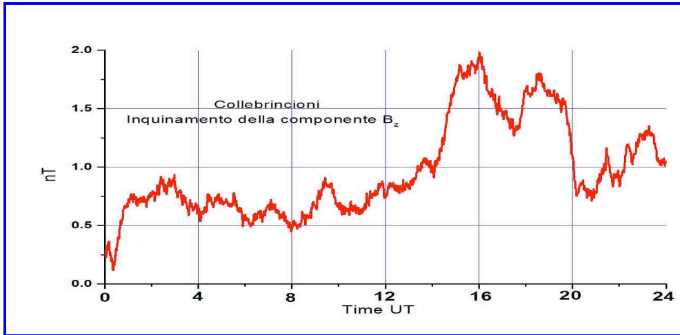
Figura 15. Inquinamento della componente verticale B_z da parte delle componenti orizzontali B_x e B_y .
