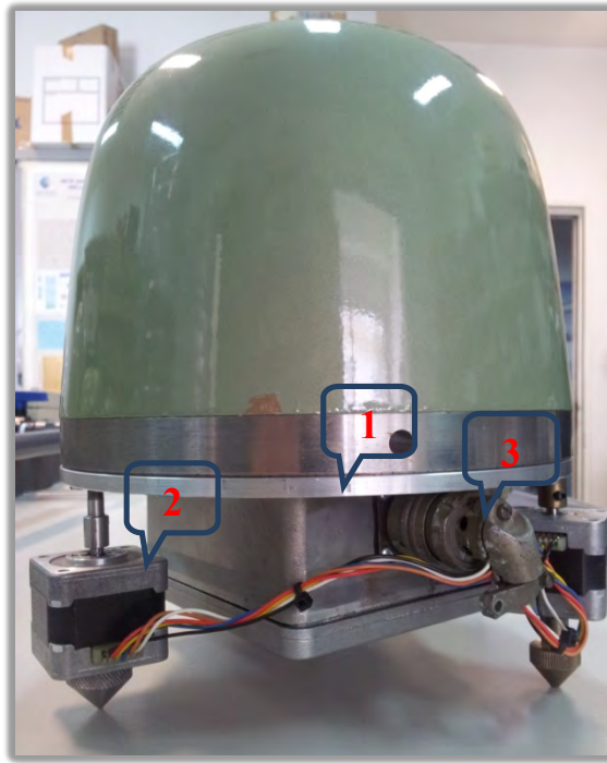
Figura 11. Particolare del SAL, assemblato sul geofono Nanometrics Trillium 40.
