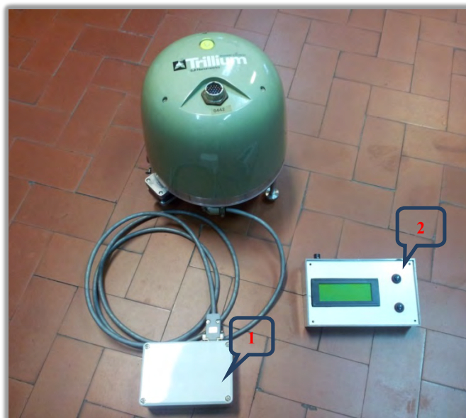
Figura 12. Il SAL, completo di contenitore per batteria e radio-modem (1) e radiocomando (2).
