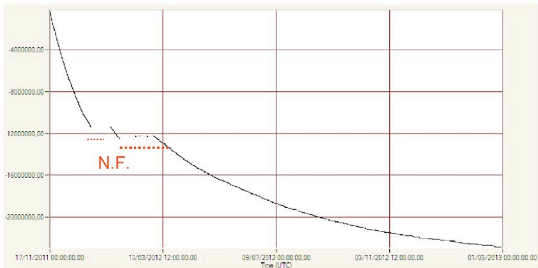
Figura 12. Segnale di strain alle stazioni DRUV (a) e DEGI (b) dal 17 Novembre 2011 al 28 Febbraio 2013. Sono stati rimossi i bruschi e marcati offset che caratterizzano il segnale, relativi all'apertura della valvola che consente il riequilibrio dello strain cumulato. Il tratteggio in rosso indica periodi in cui le strumentazioni non sono state funzionanti.
