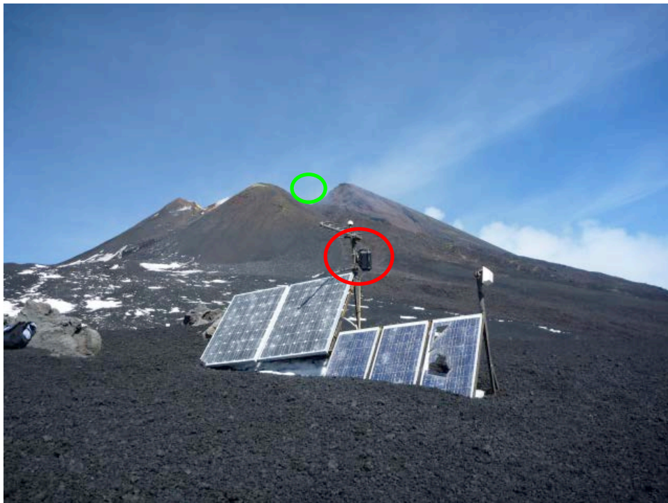
Figura 5. Vista del Nuovo Cratere di Sud - Est dal sito del Belvedere (foto del 12 aprile 2012). Nel cerchio rosso è evidenziata la collocazione del radiometro. Il cerchio verde indica la zona inquadrata dal sensore termico del radiometro.
