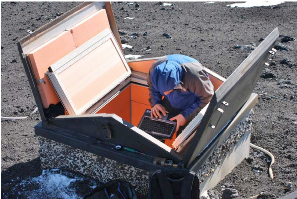
Figura 4. Configurazione e controllo software del digitalizzatore eseguita durante l'installazione in campo (EBEL).
