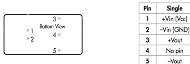
Figura 1.1.2 TEL 15-4812: disposizione e nomenclatura dei pin.
