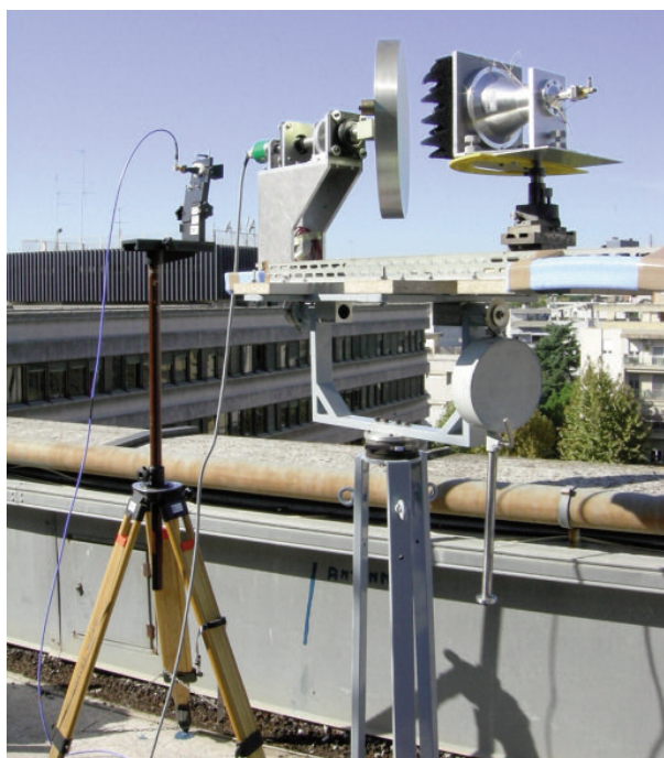
Figura 14: Setup utilizzato per le misure con l'antenna completa (a destra) sulla terrazza dell'ISCOM. L'antenna calibrata (a sinistra) è stata utilizzata per la misura del guadagno con il metodo del confronto.
