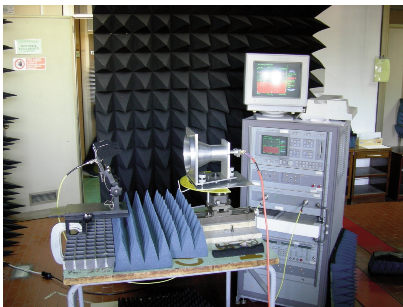
Figura 5: Setup utilizzato per le misure con il feed-horn in campo vicino
