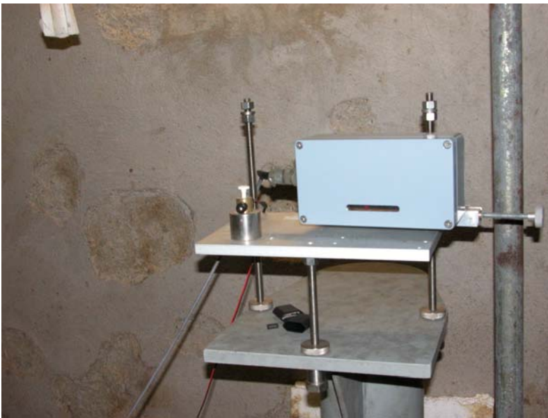
Figura 2. Rivelatore PSD. Il rivelatore, in una scatola stagna, contiene il rivelatore un processore che condiziona l'uscita e produce un segnale seriale per il collegamento al calcolatore d'acquisizione. La feritoia nera è l'ingresso ottico dove incide la luce laser riflessa dal pendolo.
