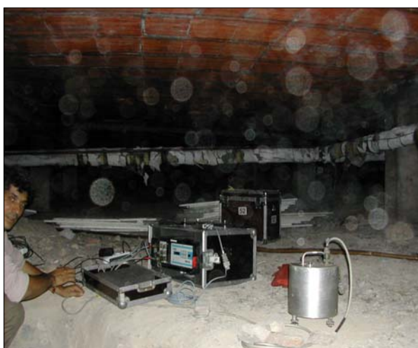
Figura 14 Stazione “BAG2” installata sul bedrock sotto le fondazioni dell'edificio comunale delle scuole, Comune di Bagolino.
