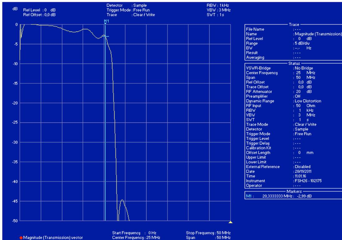
Figura 13. Schermata strumentale a 3 dB.
