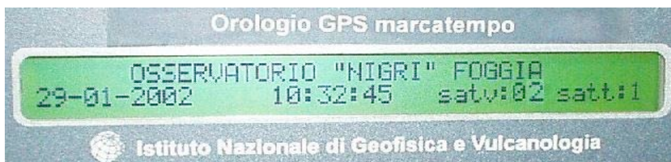
Figura 3. Display LCD dell'orologio GPS. Sulla seconda riga a destra si trovano le informazioni sul numero dei satelliti visibili (satv) e quelli agganciati (satt).
