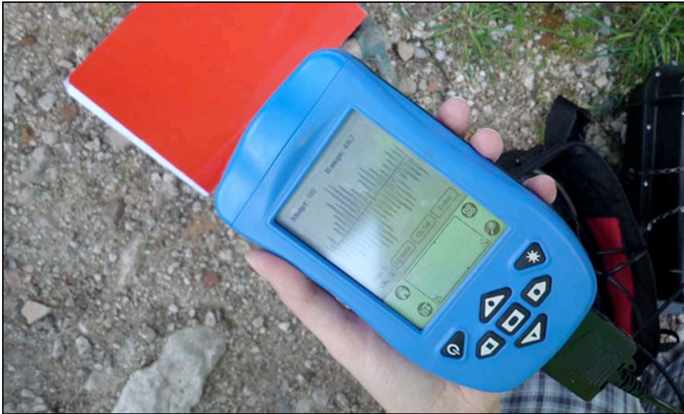
Figura 9. Palmare dotato di copertura protettiva, utilizzato per la configurazione degli acquisitori, per lo start delle acquisizioni e per il controllo del segnale.
