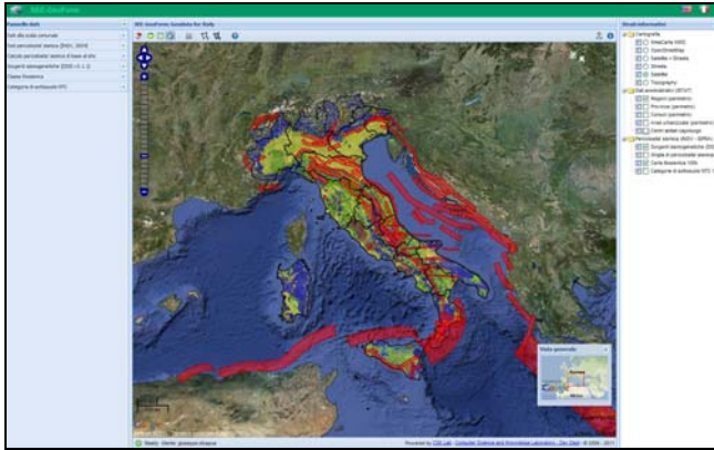
Figura 2. Il WebGIS SEE-GeoForm. In alto a sinistra il “Pannello dati”. Al centro l’ “Area di visualizzazione”. In alto a destra gli “Strati informativi” attivabili. Nella figura sono stati visualizzati contemporaneamente la cartografia satellitare di Google, la Carta Litosismica in scala 1:100.000 e le sorgenti sismogenetiche composite del DISS v3.1.1.
