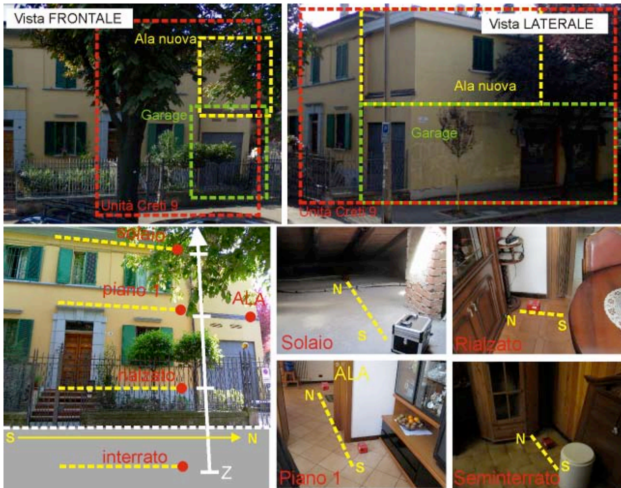
Figura 17. L'edificio utilizzato per il rilievo delle vibrazioni e le stanze in cui è stato collocato il Tromino. In alto sono mostrate due viste, frontale e laterale, dell'edificio di interesse. In basso è riportato uno schema in cui si può capire la collocazione del tromometro, impostata per eseguire misure circa sulla stessa verticale. Si osservi come lo strumento sia sempre posato in modo da mantenere la stessa orientazione nello spazio, con l'asse maggiore parallelo all'asse maggiore dell'edificio (linea gialla tratteggiata). Nota: la direzione NS si riferisce agli assi dello strumento in coincidenza con le direzioni principali della struttura osservata.
