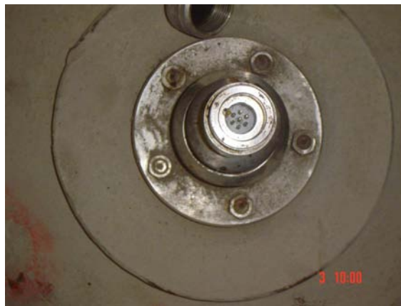
Figura 2.9. Particolare del connettore elettrico originale (7 pin).
