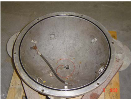
Figura 2.7. Vista della semisfera inferiore prima e dopo le migliorie; all'interno sono ben visibili a) la manichetta nera del sensore di pressione originariamente utilizzato (montato internamente); b) il water detector (al centro, con i cavi di collegamento rossi); c) i tre supporti per il montaggio del gravimetro.
