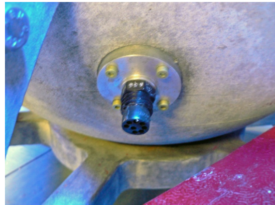
Figura 2.6. Vista della porta del sensore di pressione originale e relativa modifica.
