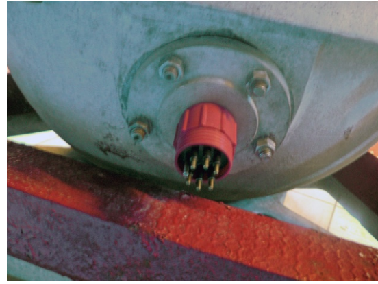
Figura 2.5. Flangia cieca posta sulla semisfera inferiore (punto di ingresso del cavo ombelicale in una precedente versione dello strumento) prima delle migliorie; qui è stato montato il connettore del nuovo cavo ombelicale.
