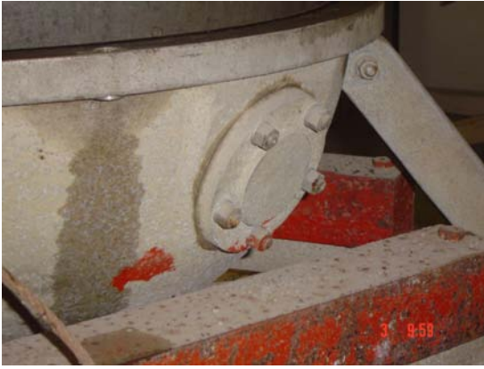
Figura 2.5. Flangia cieca posta sulla semisfera inferiore (punto di ingresso del cavo ombelicale in una precedente versione dello strumento) prima delle migliorie; qui è stato montato il connettore del nuovo cavo ombelicale.
