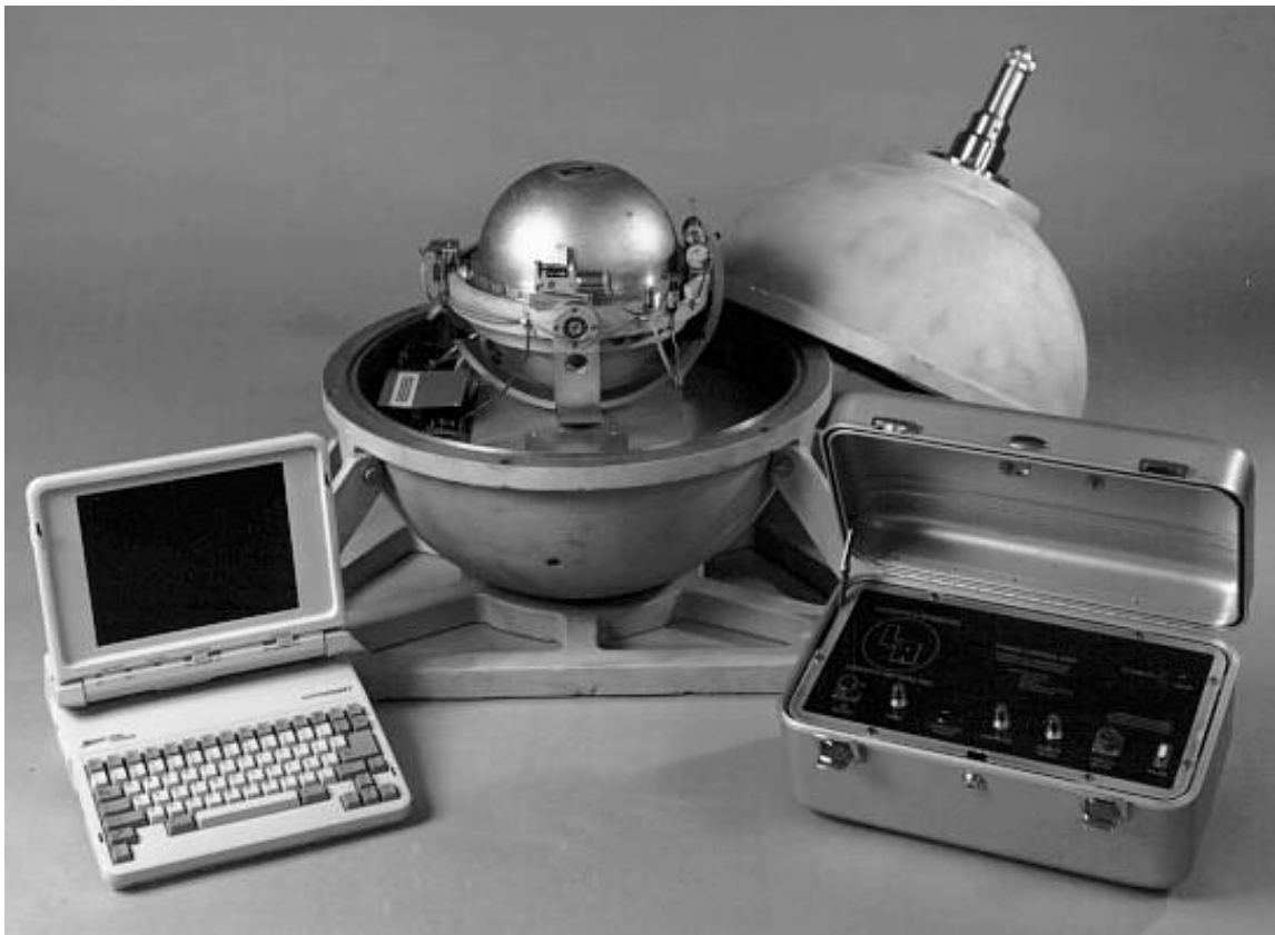
Figura 1.1. Il gravimetro da fondo LaCoste & Romberg, modello U.
