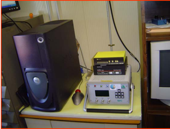
Figura 4 – Il ricevitore GISTM (GPS Ionospheric Scintillation and TEC Monitor) installato a MZS. Questa stazione e' parte di un network che sara' sviluppato in ambito SCAR – Action Group “GPS for Weather and Space Weather Forecast”.
