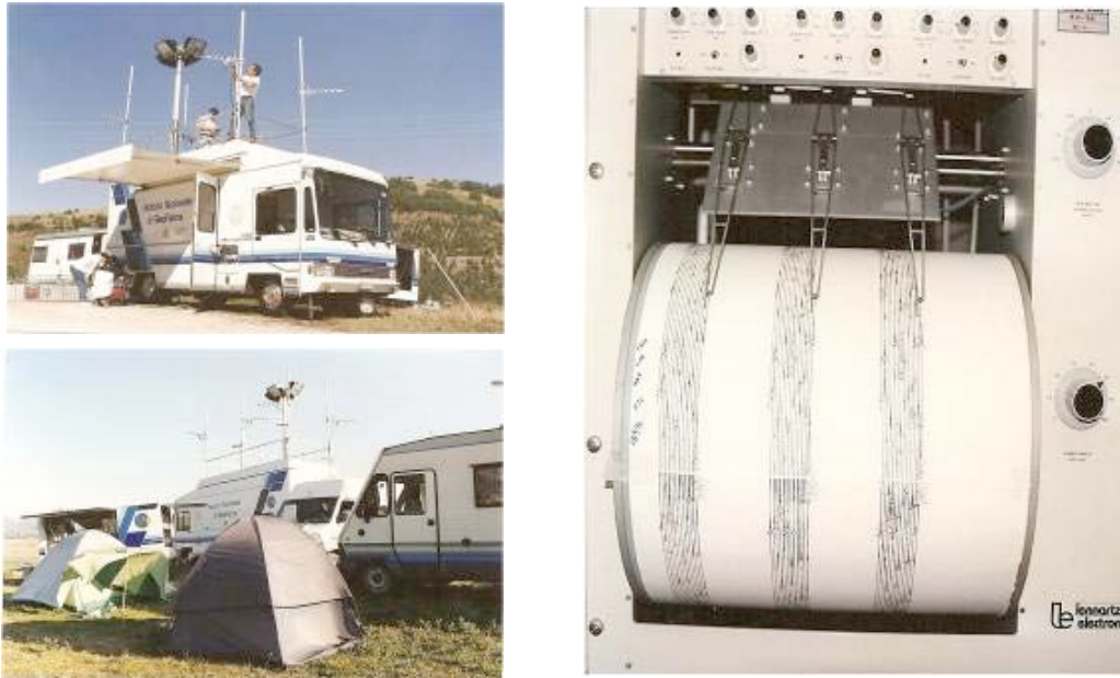
Figura 1. Il Laboratorio Mobile allestito durante la sequenza sismica di Colfiorito che ha interessato l'Umbria e le Marche tra il 1997 e il 1998. A destra uno dei rulli cartacei all'interno del Laboratorio Mobile associati alle stazioni remote installate in area epicentrale.
