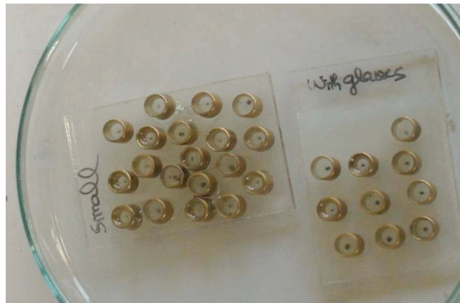
Figura 5. Cristalli di olivina inglobati da resina all'interno di piccoli cilindri cavi di ottone.
